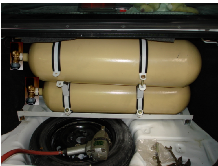
قراردهی مخزن بالایی بر روی قسمت میانی پایه مخزن و قراردهی تسمه های بالایی بر روی مخزن دوم
