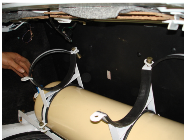
پیچهای قسمت دهانه عقبی (چپ و راست) تسمه های مخزن بالایی بیک فاصله بسته شده اند
