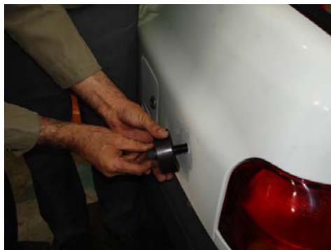
قرار گیری مغزی گردبر سمبه ماتریس در محل سوراخکاری شده
