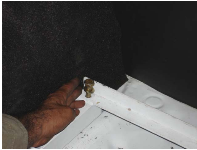
استفاده از پیچ و مهره و واشرهای تخت و فنری جهت اتصال پایه مخزن به کف خودرو
