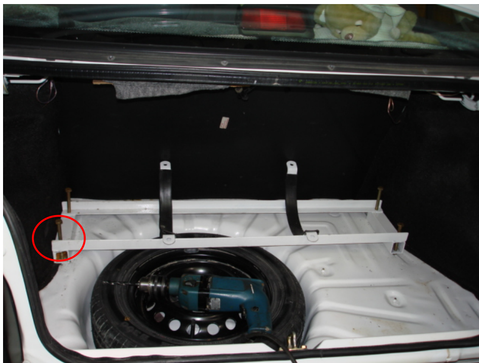
استفاده از پیچ با طول کوتاهتر یا بهره گیری از مهره هرز در مورد یکی از اتصالات پایه مخزن
