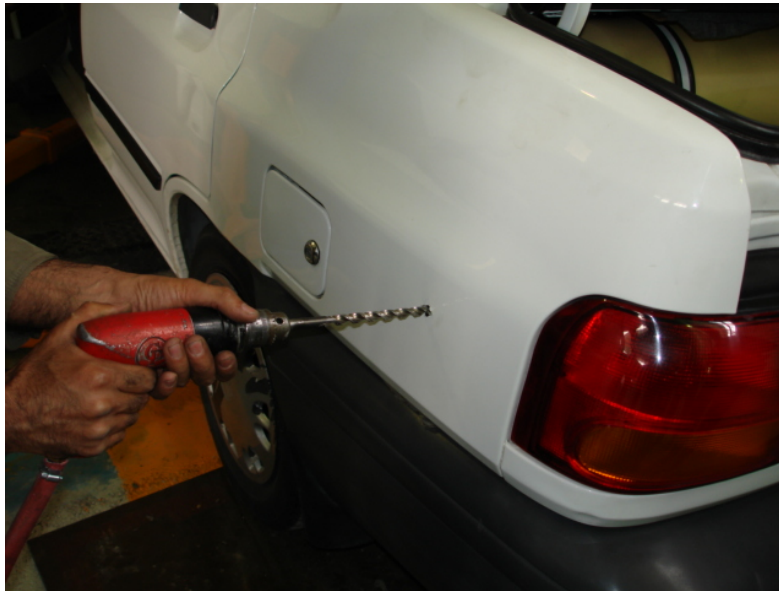
استفاده از دریل برای سوراخ کاری محل قرار گیری مغزی گردبر سمبه ماتریس
