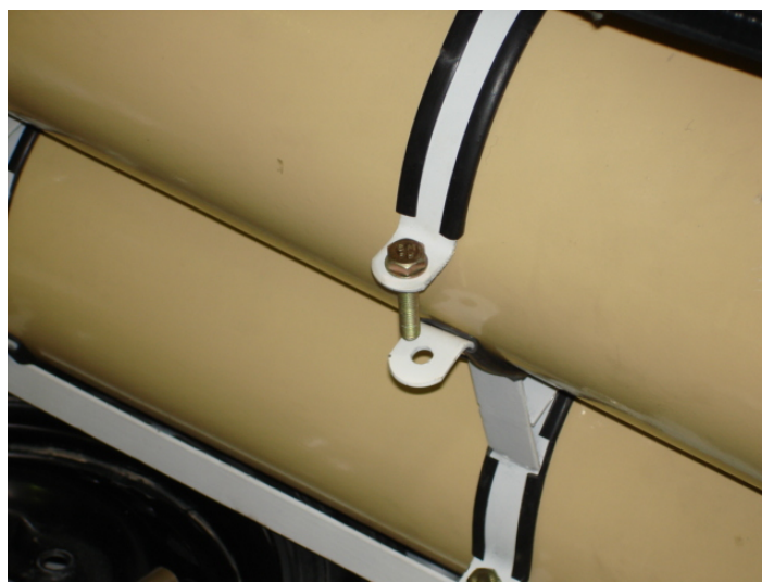
فاصله بیش از حد دهانه تسمه و پایه مخزن میانی
