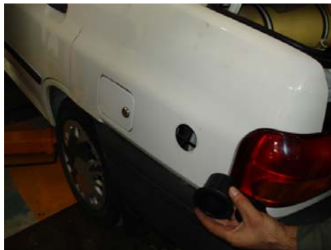
بدنه بریده شده خودرو برای نصب شیر پرکن
